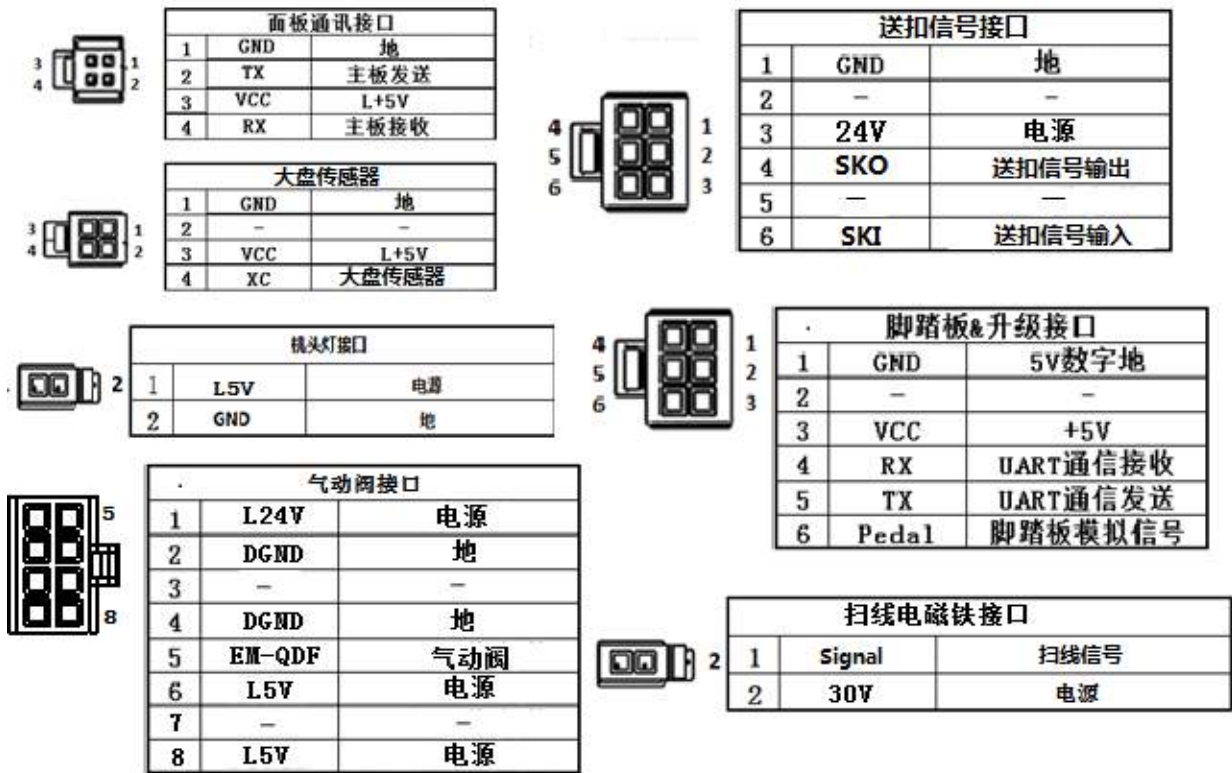
图 1-2-2 控制器接口定义 (controller connection plug definition)
