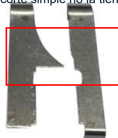
双切布压脚弹簧片 Lámina de resorte del prensatelas de corte doble
