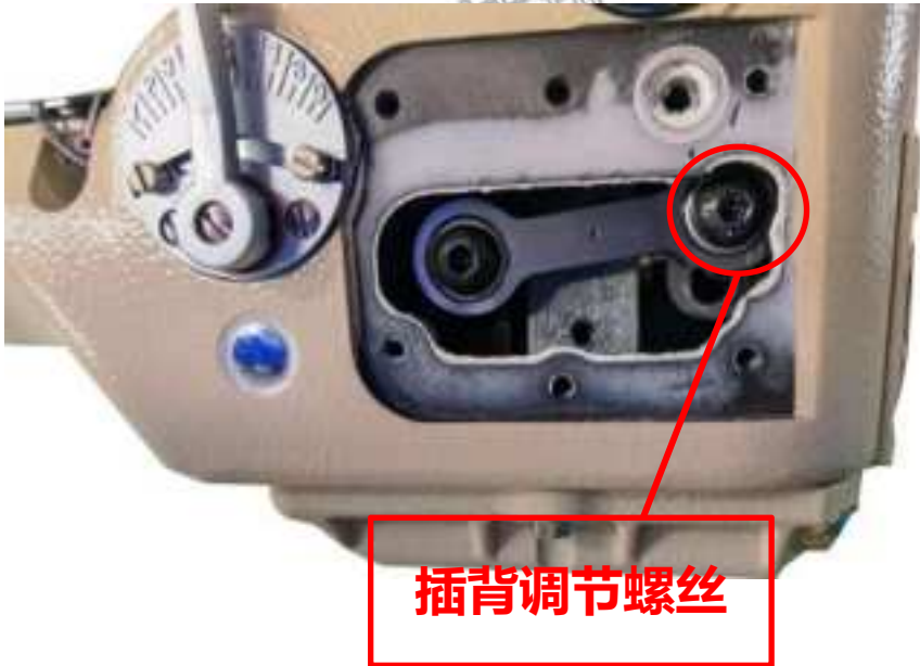
Tornillo de ajuste de la profundidad de inserción posterior
