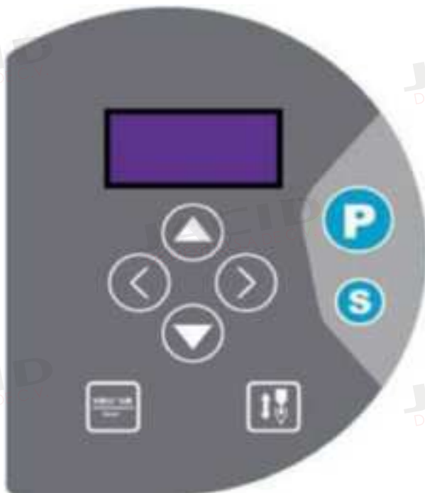
Figura 2-1 Interfaz de apariencia del panel de operación
