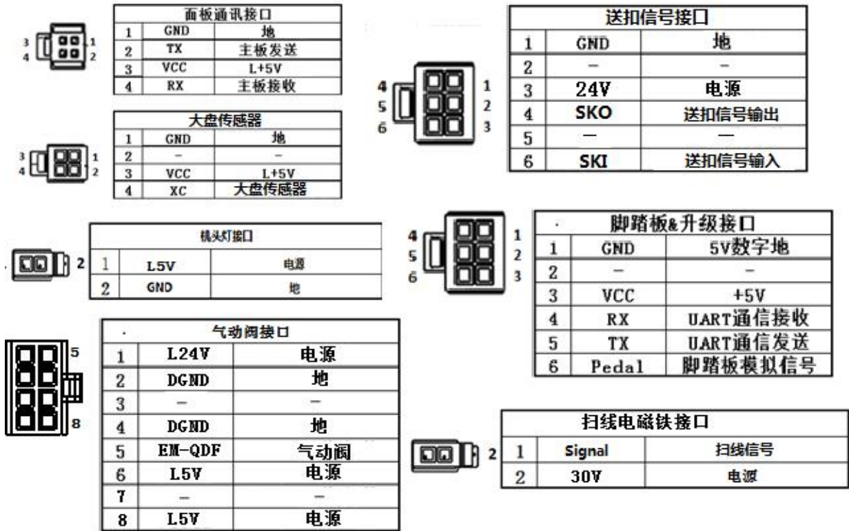
图 1-2-2 控制器接口定义 (controller connection plug definition)
