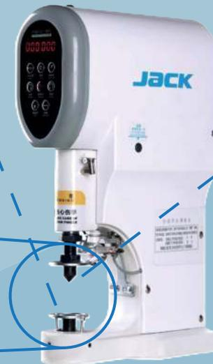
Pantalla HD de control para ajustar digitalmente la presión y la velocidad
